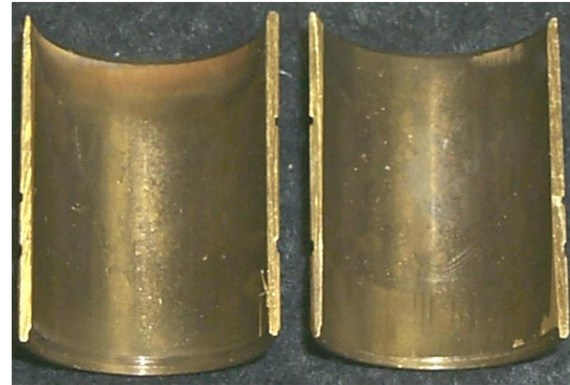
Teilansicht der Buchse einer Axialkolbenpumpe
